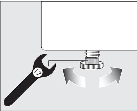
Durch Drehen der Schraubfüße (von Hand oder mit einem flachen Maulschlüssel) werden Bodenunebenheiten ausgeglichen.
