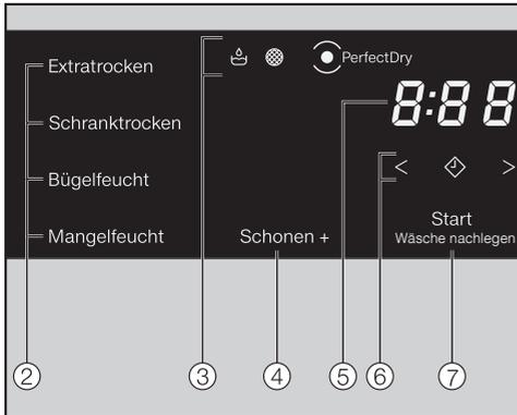
Die Sensortasten ②, ④, ⑥ und ⑦ reagieren auf Berührung mit den Fingerspitzen. Die Auswahl ist möglich, solange die jeweilige Sensortaste beleuchtet ist.
