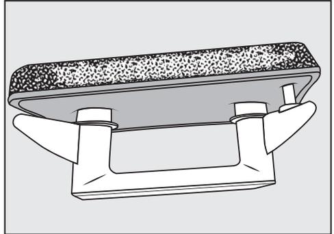
Die Rückstände sind auf Faserrückstände der Wäsche und verbliebene Waschmittelbestandteile zurückzuführen. Rückstände finden Sie auf der Vorderseite und an den Seitenrändern des Sockelfilters. In Extremfällen bilden Rückstände hartnäckige Verkrustungen. Die Rückstände sind ein Zeichen dafür, dass der Sockelfilter nicht mehr passgenau an den Seitenrändern anliegt, auch wenn er einwandfrei aussieht: An den Rändern werden Flusen ungefiltert eingeblasen.
